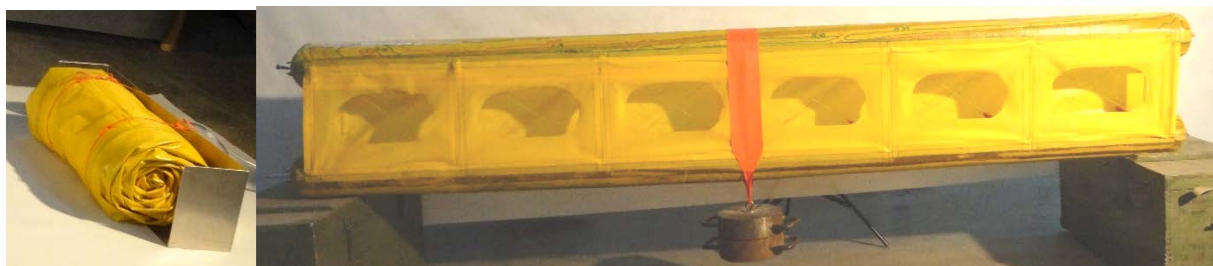
Рисунок 9. Рулон с мягкой НОК; испытания отвержденной НОК каркаса
