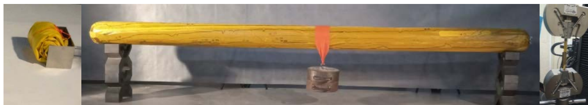
Рисунок 6. Рулон с мягкой НОК, испытания НОК балки L=3 \text{ м} , D = 0,17 \text{ м} , отвержденный образец ПКМ НОК
