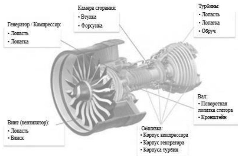
Рис.4 Конструкция ДУ с применением АМ-технологий
