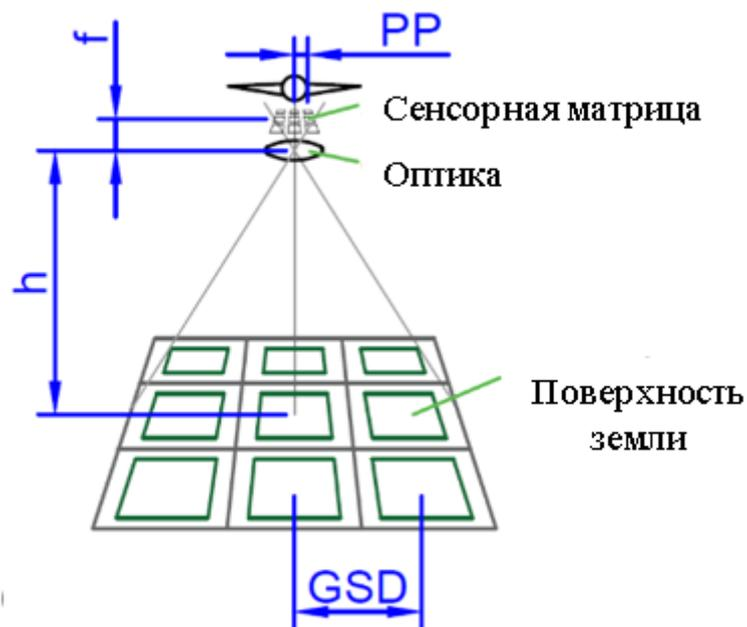
Рис. 1. Взаиморасположение компонентов уравнения (1) в случае проецировании матрицы фотоприемника на земляную поверхность под прямым углом
