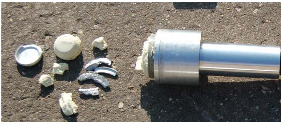
Рисунок 7. Изделие с демпфером с наполнителем после испытания на полигоне
