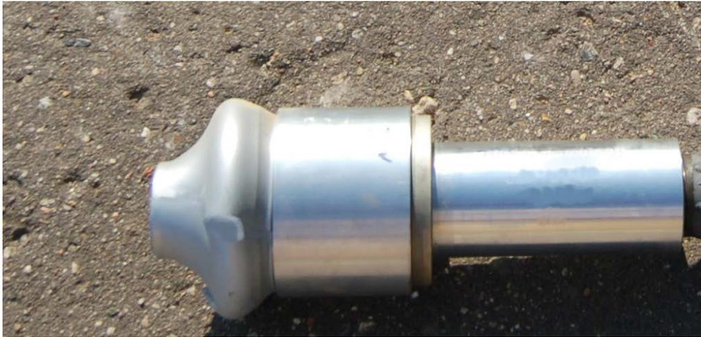
Рисунок 5. Изделие с демпфером без наполнителя после испытания на полигоне
