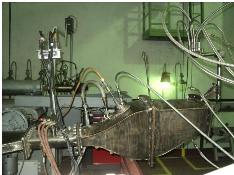
Рис.1 Отсек камеры сгорания
