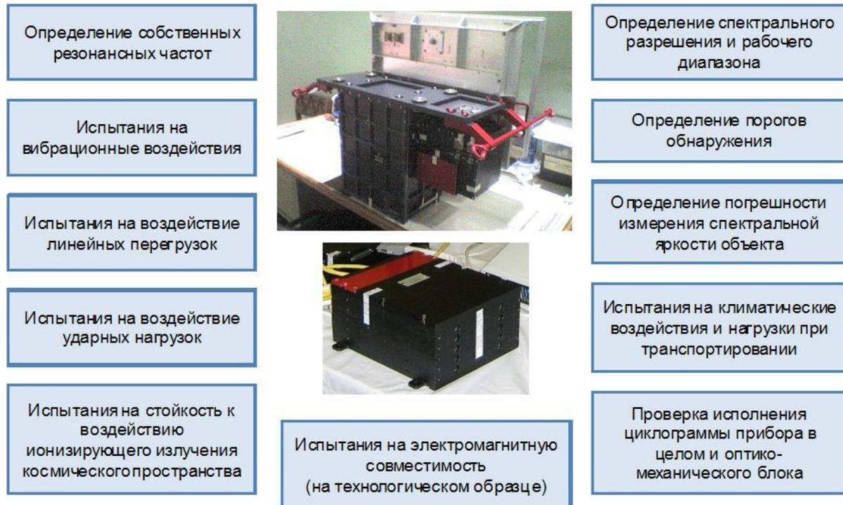
Рисунок 9. Состав предварительных испытаний аппаратуры ИКФС-2.
