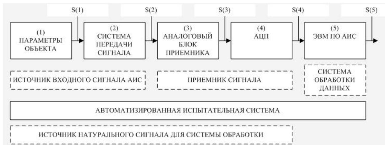
Рисунок 1 – функциональная схема АИС
