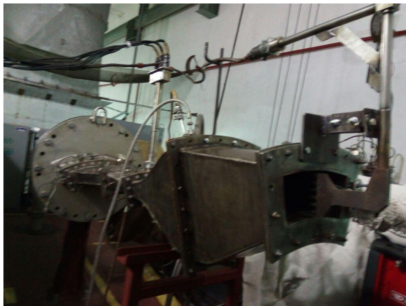
Рис.1. Отсек камеры сгорания установленный на стенде
