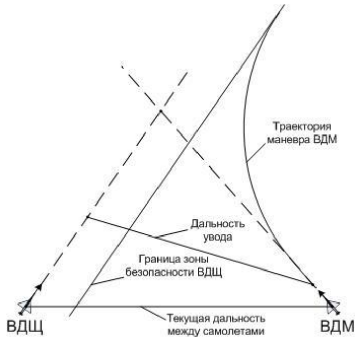
Рис. 3. Геометрическое построение, используемое для вычисления дальности увода
