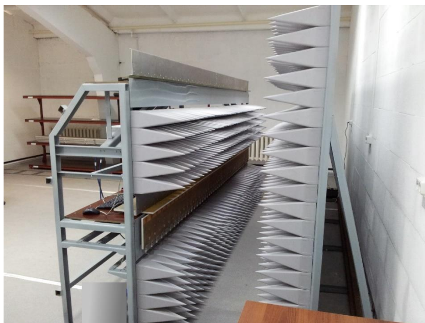
Рисунок 12 - Взаимное расположение ЗУ (снизу) и КАР при измерениях.
